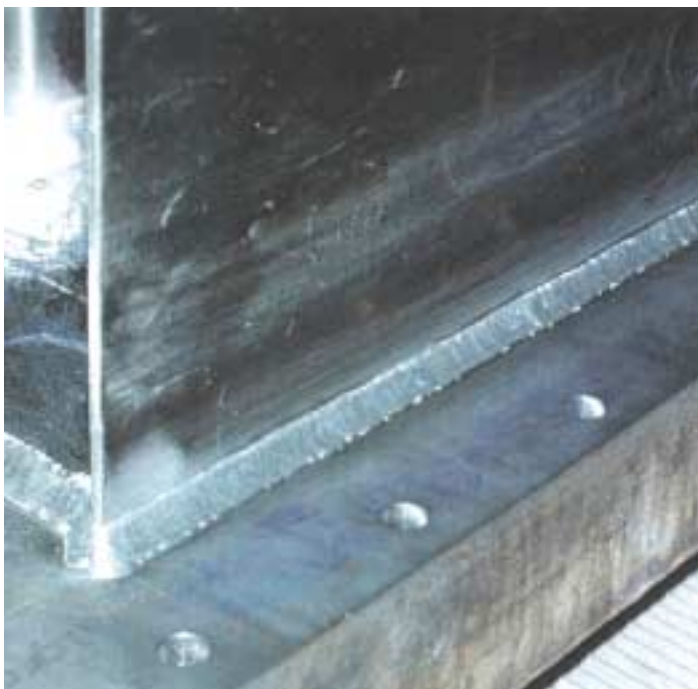
Konstruktionsschweißung: Platte t = 85 mm (ALZnMgCu0,5), Wanne t = 4 mm (ALMg3)
