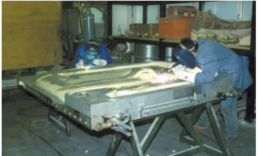
Schweißen eines dickwandigen AL-Werkzeuges ohne Vorwärmen (in der Realität ist eine Trennwand als Blendschutz angebracht)
