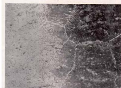
Abb. 60 Eisen-Stahl-Stumpfschweißung Vergr. = 126 (142)
