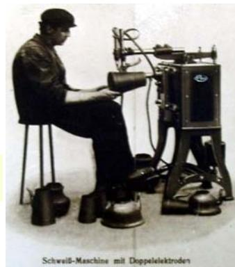
Schweiss-Maschine mit Doppel-Elektroden
