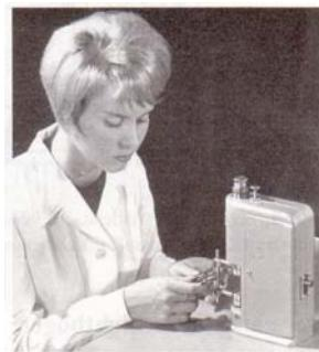
Bild 8. Feinpunktschweißen an Kleinteilen mit einer Maschine der Firma PECO, München-Pasing 1962.
