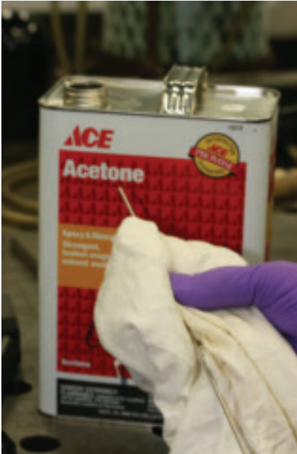
Fig. 9 — Clean the filler rod.
