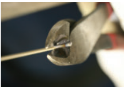
Fig. 10 — Clip rod end.
