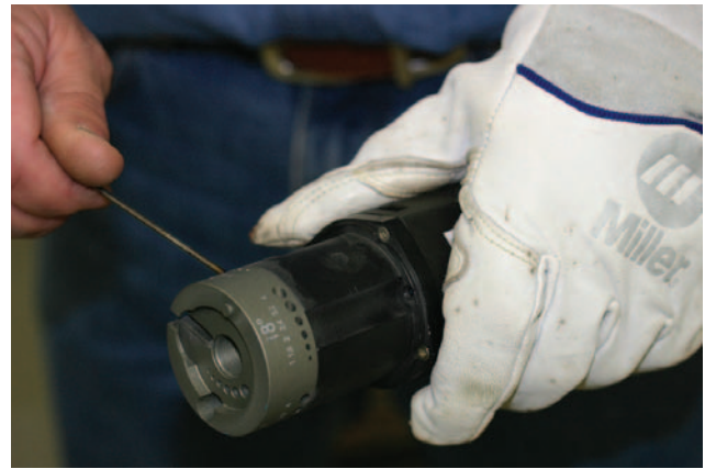
Fig. 2 — Esmerila o lija el tungsteno.
