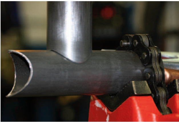
Fig. 5 — Junta de silla o sillín.
