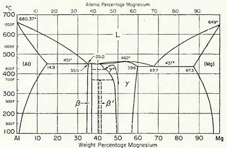
Fig. 7—Al-Mg phase diagram
